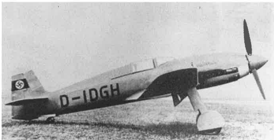
Mit dieser Heinkel He 100 V 8 mit serienmäßigem DB 601-A Motor stellte Dieterle mit 746,606 km/h einen neuen absoluten Geschwindigkeitsrekord auf.
